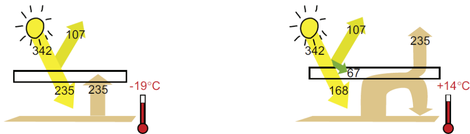
Flux d'énergie en W/m 2 sans et avec gaz à effet de serre (GES)
